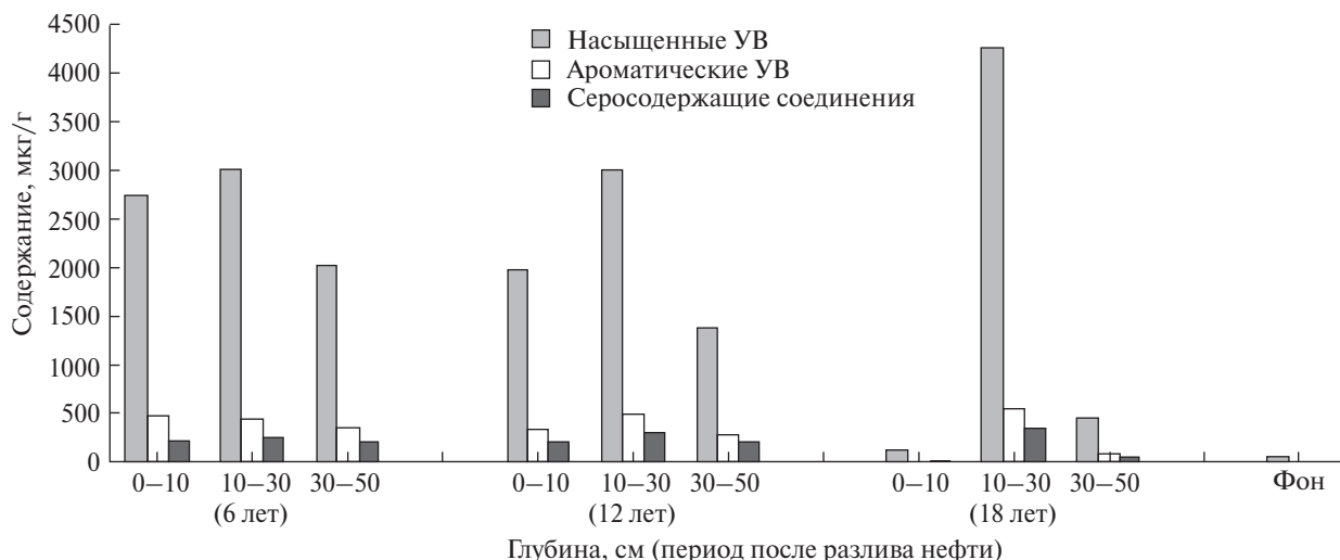
Рис. 1. Групповой состав экстрактов из нефтезагрязненных и фоновой торфяных почв различного срока давности загрязнения.
