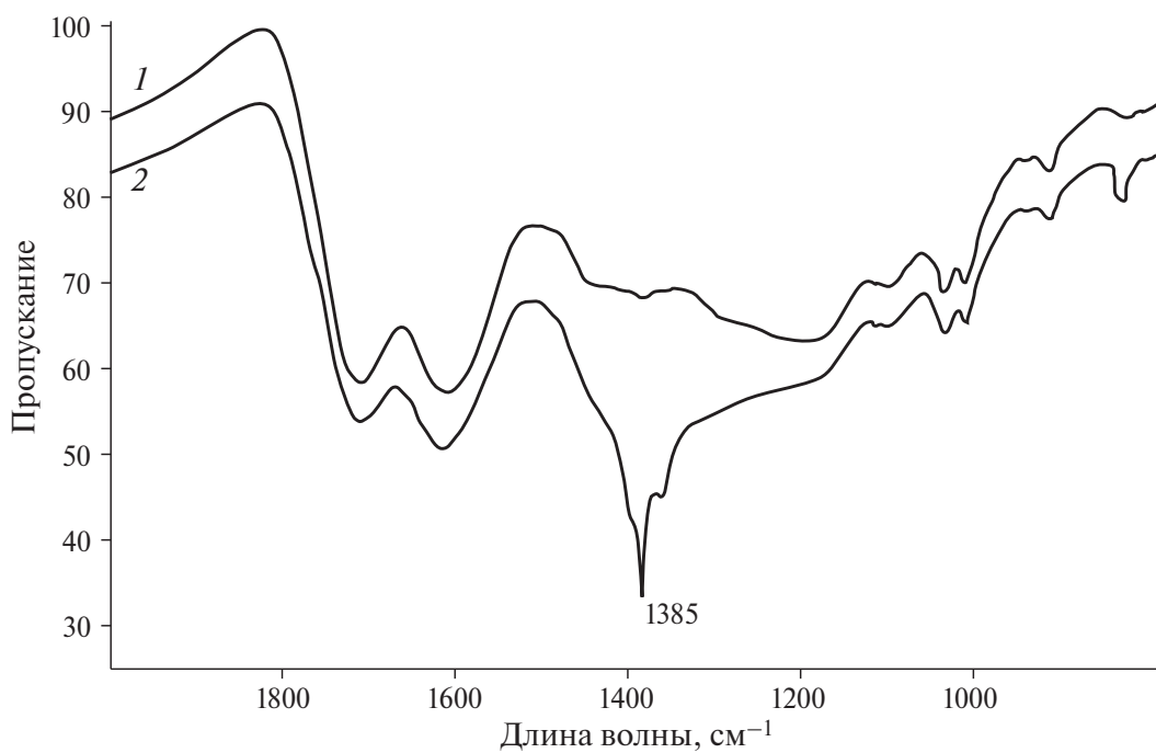
Рис. 2. ИК-спектры: 1 – ГК необработанные; 2 – ГК после барьерного разряда в присутствии воздуха.
